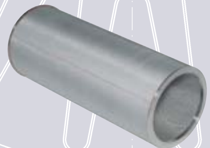
Cylindres en POROSTAR®, avec anneaux à bride. Jonctions longitudu et circulaires collées. Dimension: \varnothing 230 mm, longueur 570 m
